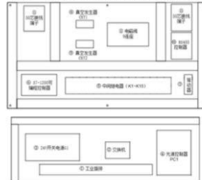
①工业插排; ②交换机; ③24V 开关电源 G1; ④光源控制器; ⑤中间继电器 (K1-K15); ⑥S7-1200 可编程控制器; ⑦驱动器; ⑧真空发生器 CKT1; ⑨真空发生器 CKT2; ⑩RS485 控制器; ⑪50 芯接线端子; ⑫电磁阀 9 连座
