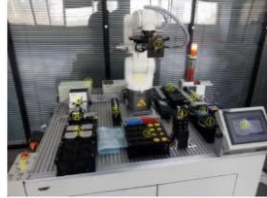
①TCP 练习组件; ②模拟装配组件; ③分拣料盘; ④同轴光源 (含工业摄像头); ⑤可替换笔芯库; ⑥机器人本体; ⑦机器人工具; ⑧码垛料盘; ⑨码垛流水线; ⑩冲压下料区; ⑪冲压上料区; ⑫冲压气缸; ⑬螺丝机; ⑭螺丝板物料固定装置; ⑮打螺丝; ⑯冲压物料取放区; ⑰外部按钮; ⑱触摸屏
