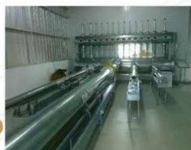
气体流量标准装置 装置不确定度: 0.32% ( k=2 ) 检校仪表口径: DN15~DN300
