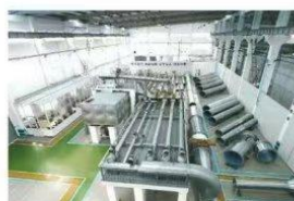
液体流量标准装置 装置不确定度: 0.033% ( k=2 ) 检校仪表口径: DN2~DN2400
